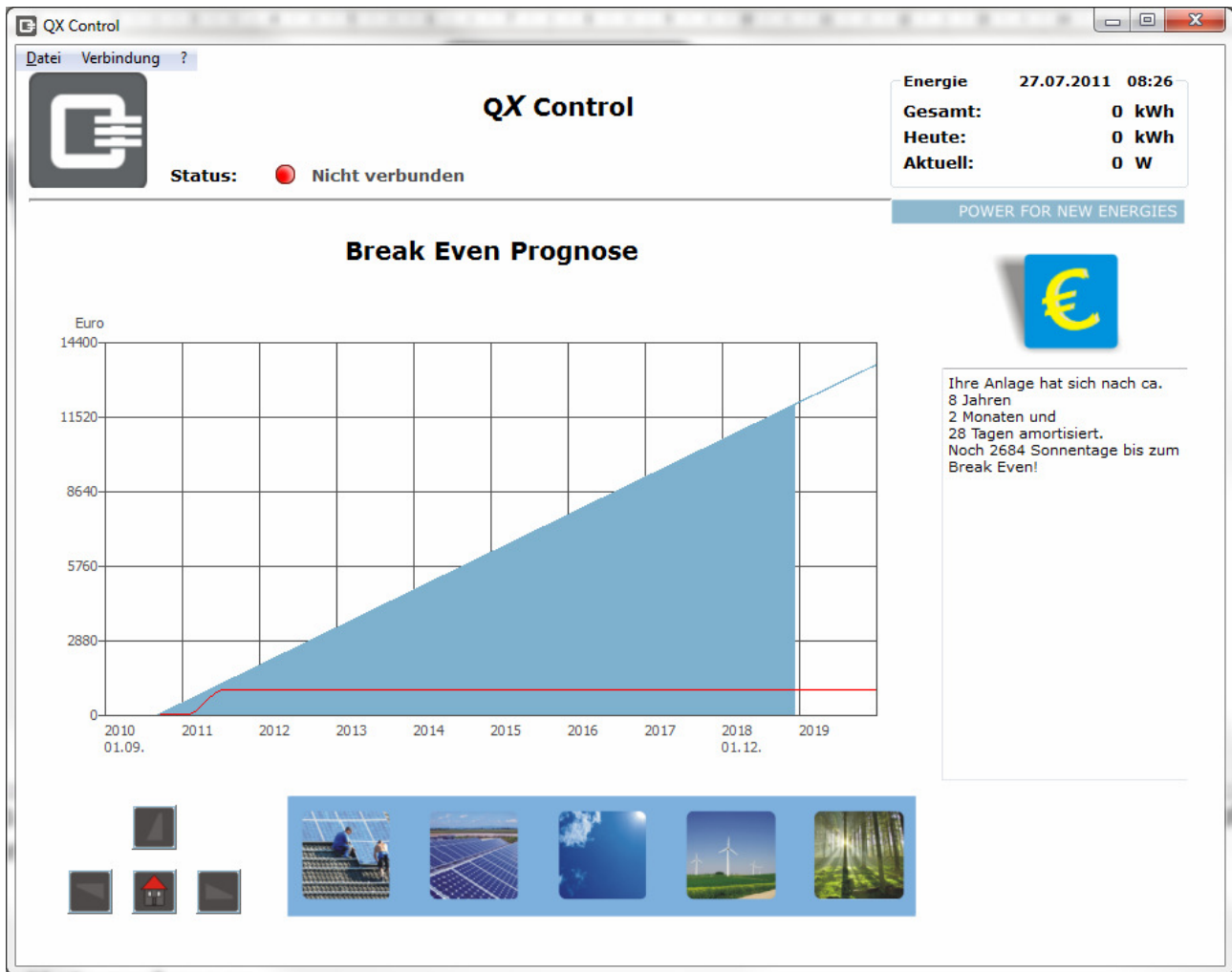
Abb. 2: Die Break Even Prognose zeigt an, wie lange es voraussichtlich dauern wird bis sich die PV Anlage amortisiert hat.
